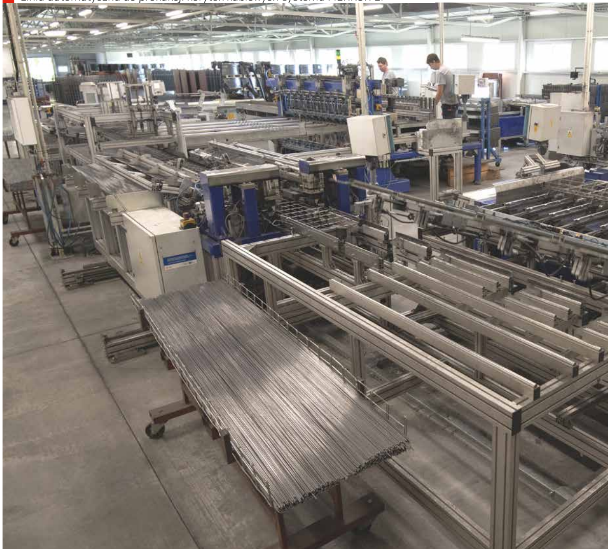
✓ Linia automatyczna do produkcji korytek kablowych systemu MERKUR 2.
