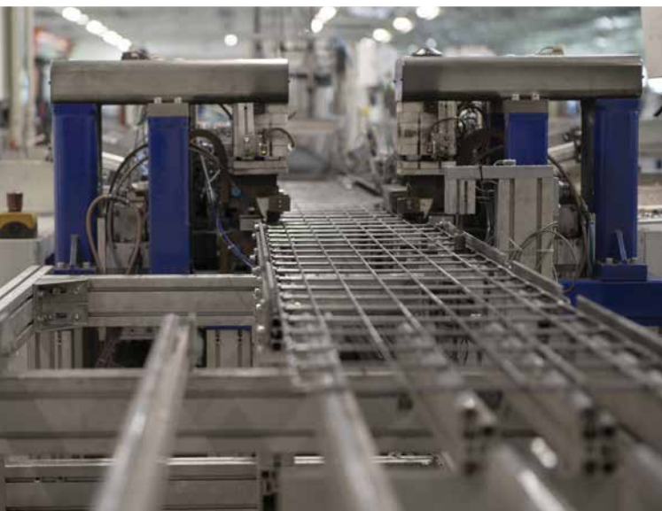
◀ ▶ Średnioczęstotliwościowe centra do zgrzewania drucianej konstrukcji korytek MERKUR2.
