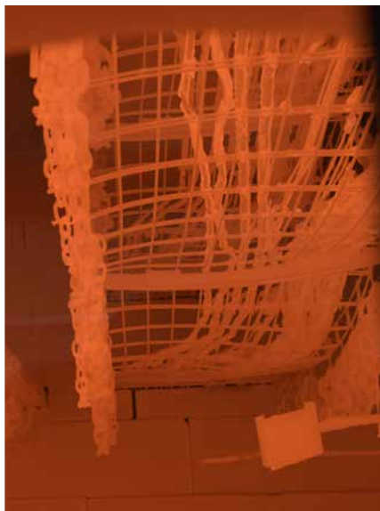
◀ Widok testowanych tras kablowych w komorze do prób i w trakcie próby odporności pożarowej.
