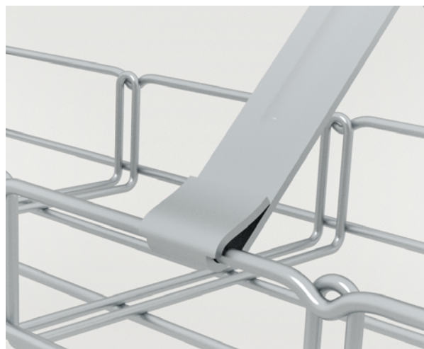
▲ Po instalaci je nutné zajistit žlaby v držáku ohnutím přesahů ramen držáku.
