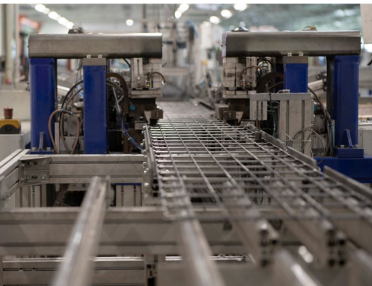
◀ ▶ Středofrekvenční svařovací centra pro svařování drátěné konstrukce žlabů MERKUR.
