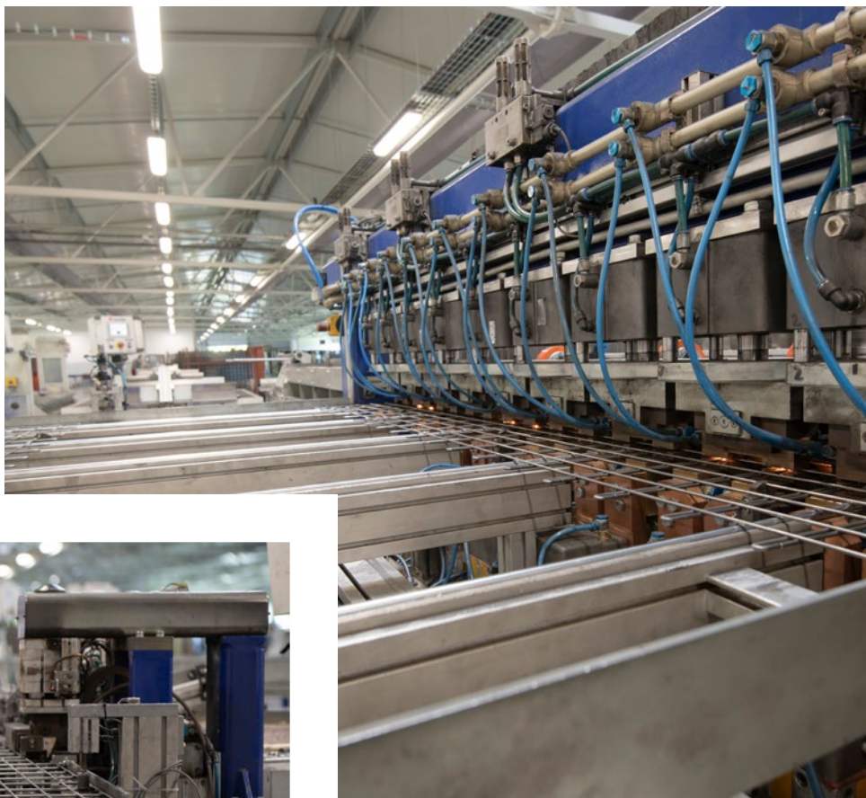
◀ ▶ Středofrekvenční svařovací centra pro svařování drátěné konstrukce žlabů MERKUR.
