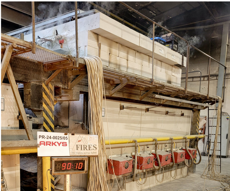
◀ ▶ Zkušební komora ve zkušebně FIRES během zkoušky našich systémů.
