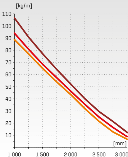
Maximální přípustné zatížení žlabů [kg/m]
