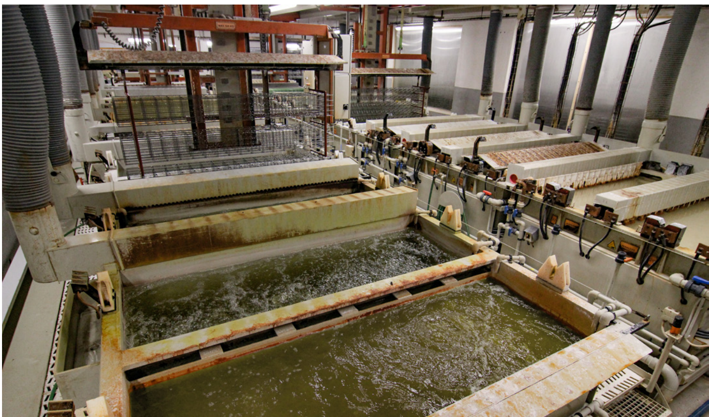
▲ Anlage des galvanischen Verzinkens im Produktionsareal in Uhřetěpe nad Labem.
