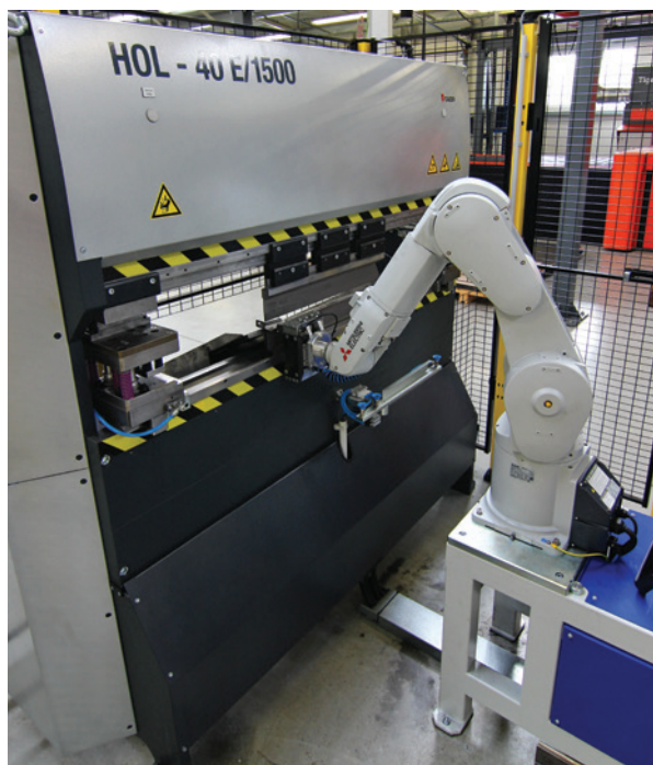
⏪ ⏩ Einer der robotisierten Arbeitsplätze der Produktion gebogener Blechelemente im Produktionsareal ARKYS.
