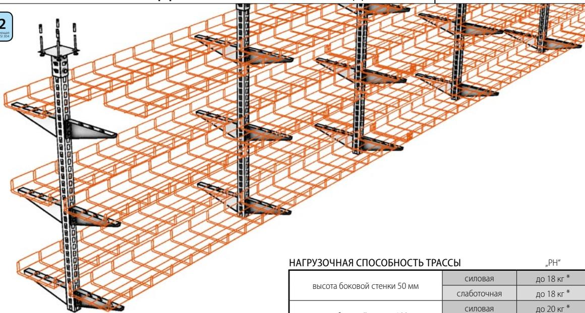
Используется для пространственного проведения трасс, укрепленных в потолке. Кабельные трассы могут быть инсталлированы в одном или более высотных уровнях на стойке. Этот способ очень выгоден для сложных трасс с пространственным перекрещиванием.
