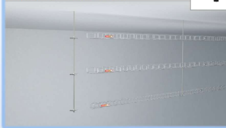
Prostorová montáž závěsná lehká na závitových tyčích a držácích DZM 13
